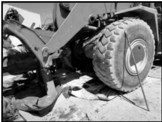
Ilustración 66. Colocación de bases plásticas y cartones con la finalidad de evitar derrames al suelo desnudo.
