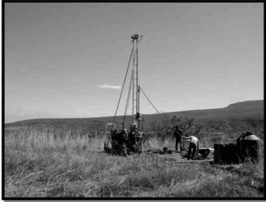
Imagen 12. Se observa parte de las actividades de muestreo para evaluación del material de extracción en el Banco el Zula, el cual se encuentra en las propuestas de bancos mencionados en las bases de licitación.
