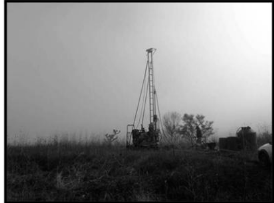
Imagen 13. Se muestra la maquinaria utilizada para la extracción de núcleos para la valoración del Banco la Capilla.
